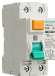
TGB1NL-63 剩余电流动作断路器（以下简称断路器）主要适用于交流 50Hz，额定电压 415V，额定电流至 63A 的电路中。当人身触电或电网泄漏电超过规定值时，剩余电流动作断路器能在极短的时间内迅速切断电源，保护人身及用电设备的安全，亦可作为线路的不频繁转换及电动机的不频繁起动之用。该产品适用于工业、商业和高层民用住宅等各种场所。
